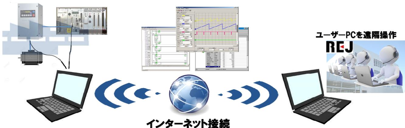
**異常発生時に、お客様のPCと専門エンジニアのPCをつなげて、制御機器のデータやプログラムの状態を遠隔モニターすることで、復旧作業を強力にサポートいたします。**
